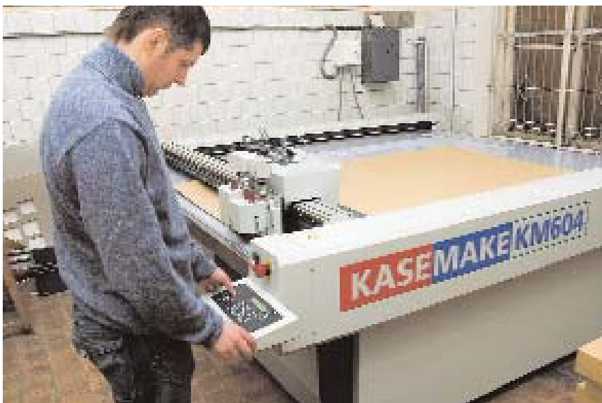
Рис. 3. Установка «Kasemake KM 604» для автоматизированного изготовления контейнеров из бескислотного картона
